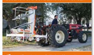
**AT 10.1:** Alimentazione a batterie 12 V con attacco di alimentazione al trattore.
